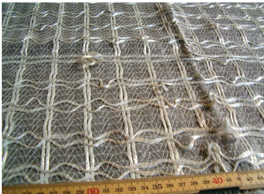
2. kép – Bevonatlan üvegszál pászmák alkalmazásának veszélyei
